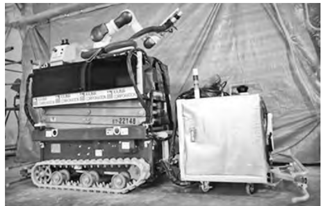
写真-1 耐火被覆吹付ロボット
