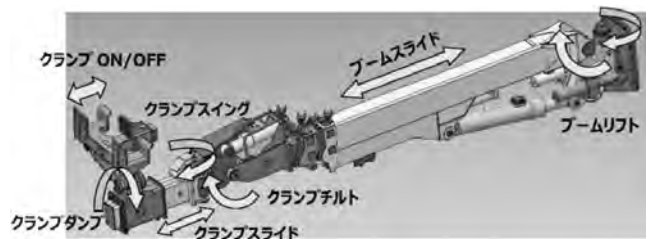
図-2 各関節のブームセンサー位置図
