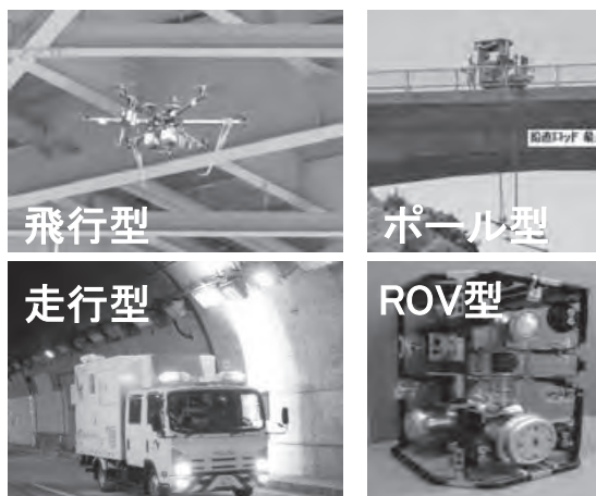
図-2 インフラ点検用ロボットの例
