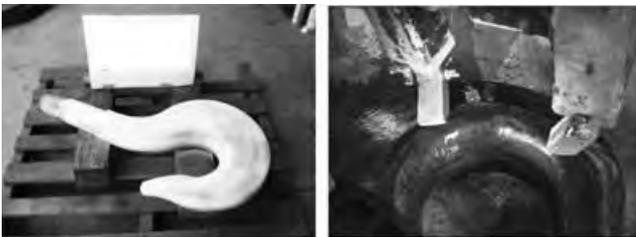
写真-5 フック分解検査
