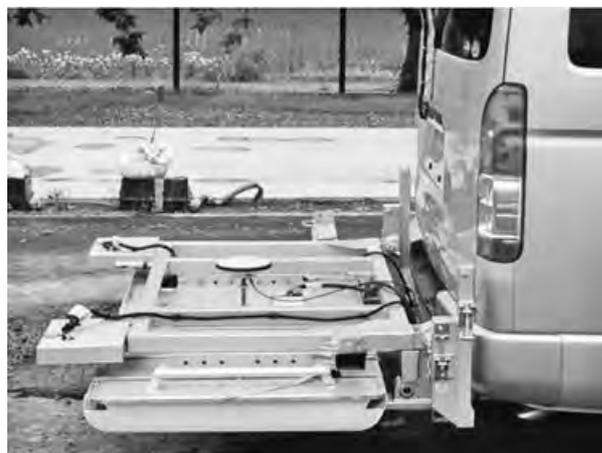
写真—1 地中レーダ探査機
