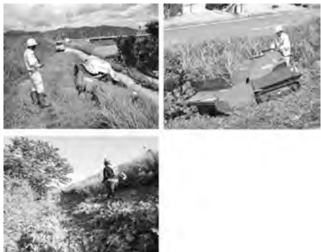
写真-1 除草機械 (左上: 大型遠隔操縦式草刈機, 右上: ハンドガイド式草刈機, 左下: 肩掛け式草刈機)
