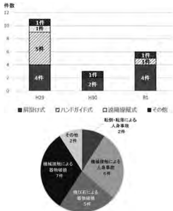
図1 除草作業における事故件数 (上：草刈機別の事故件数 (近畿地整 H29 ~ R1)) (下：除草作業中の事故発生状況 (近畿地整 H29 ~ R1))
