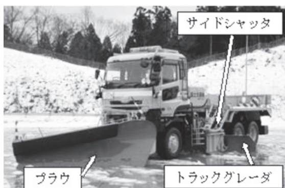
図一7 除雪トラックの主な作業装置
