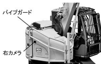
図-9 右カメラとパイプガード
