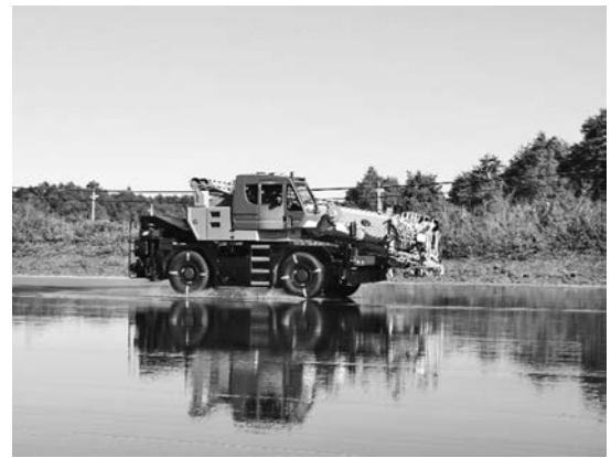
写真—5 アンチロックブレーキシステム試験状況
