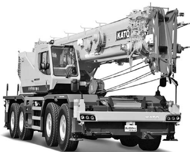
写真-1 大型ラフテレーンクレーン例 (80トン吊り)
