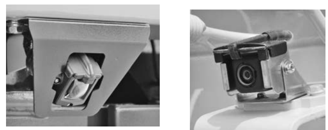
写真一 3 カメラクリーナ取付例
