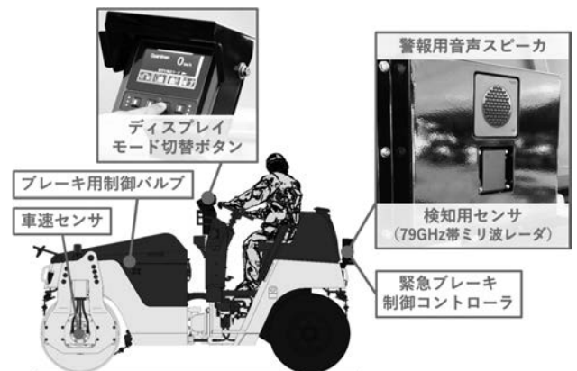
図-3 コンバインドローラにおける緊急ブレーキ装置の主要機器
