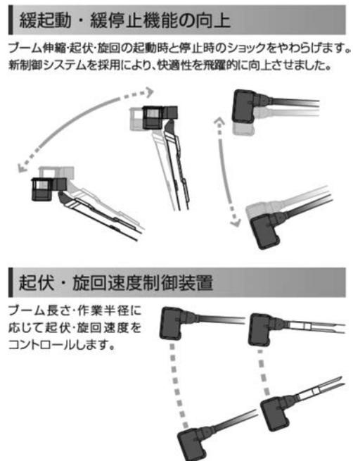
図—3 作動速度制限と緩起動・緩停止機能
