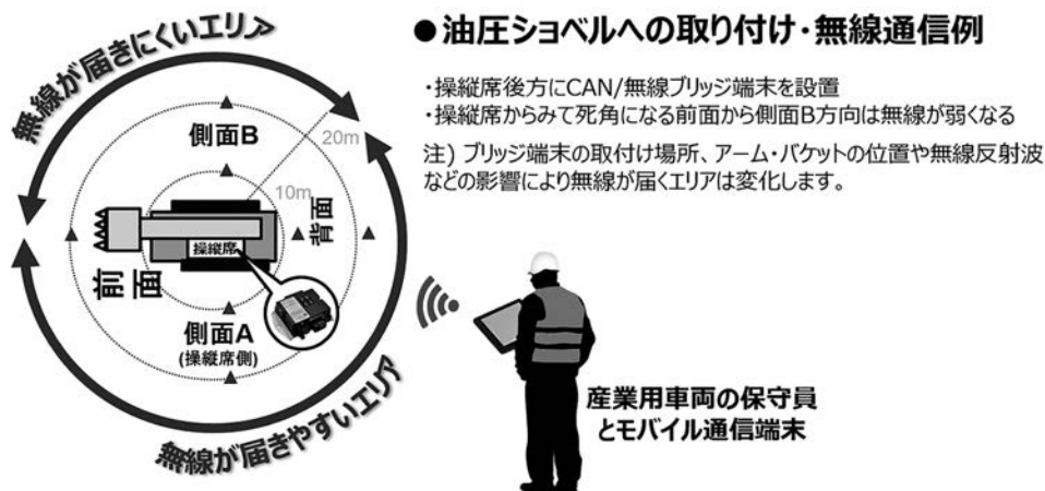
図-4 産業用車両内への端末設置とその無線通信傾向の例
