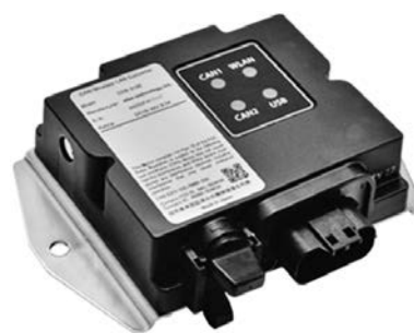
写真一 CAN/無線LANブリッジ筐体外観(サイレックス・テクノロジー製 CBR-100AC)
