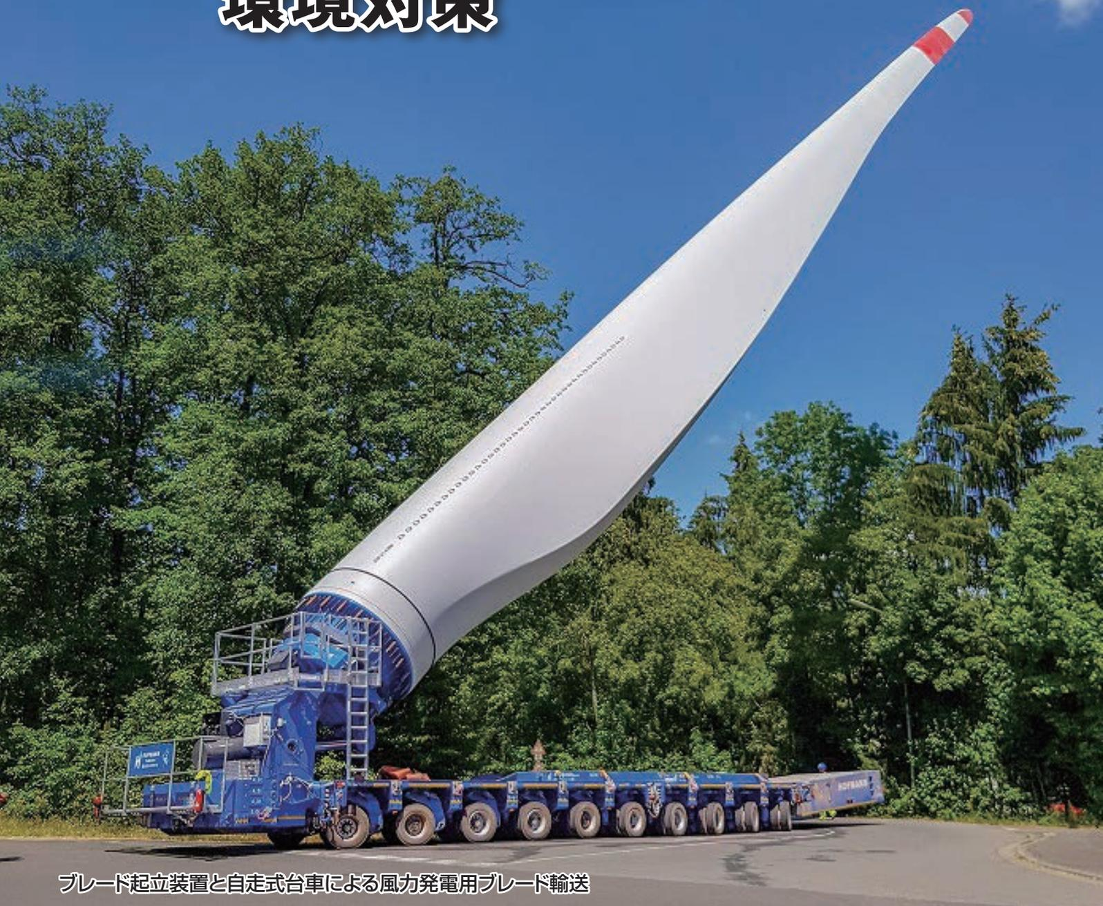
ブレード起立装置と自走式台車による風力発電用ブレード輸送
