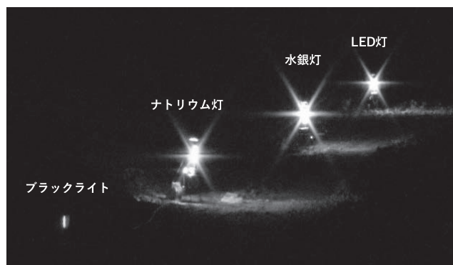
写真—2 異なる光源を用いた誘虫試験の様子
