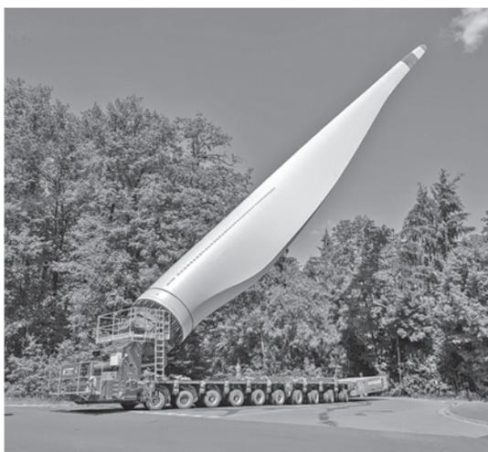
写真一5 ブレードを起立させることで平面上の全長を短縮する
