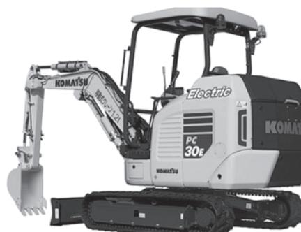
図—1 バッテリー駆動式ミニショベル
