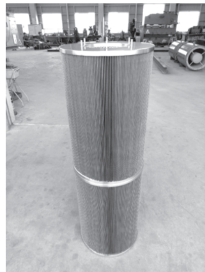
写真-1 プリーツフィルター
