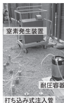
図一5 実汚染サイトでの浄化菌液の供給状況と浄化効果
