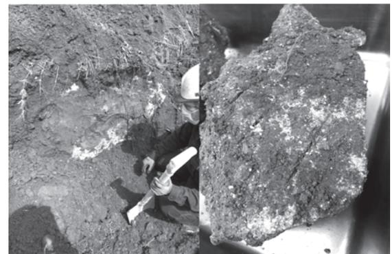
写真—4 屋外施工試験と掘り起こした改良体
