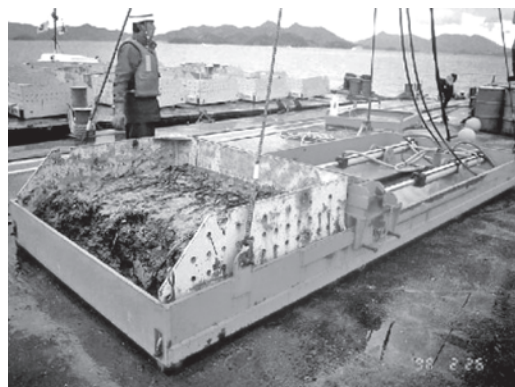
写真一 アマモ採取・移植バケット（現在アマモ移植は市民活動が担い、移植関係装置はスクラップとなった）
