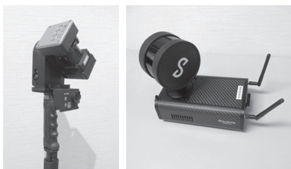
写真-1 LiDAR SLAM システム
