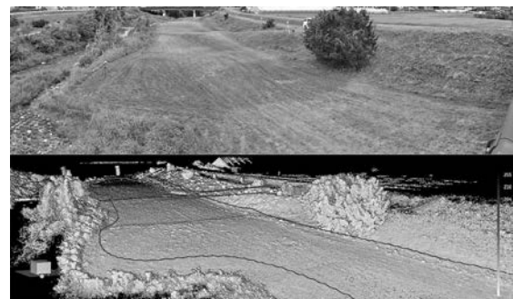
写真—7 計測現場の写真（上）と SLAM 計測データ（下）
