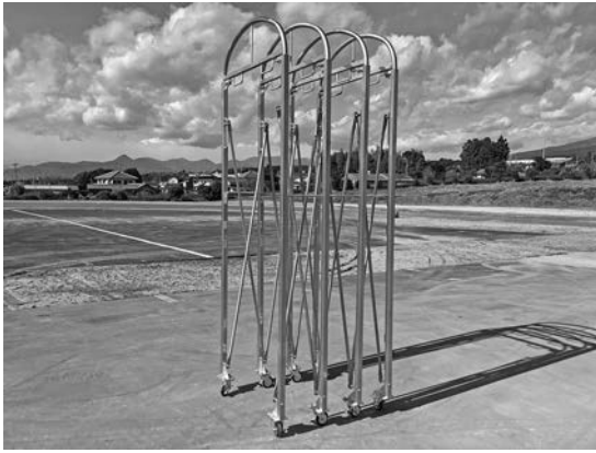
写真-3 スチールフレームの折りたたんだ状態
