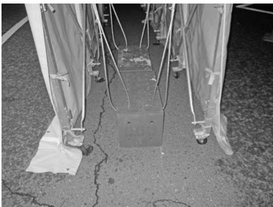
写真-5 内臓ワイヤによる重しの固定状況および移動用の車輪
