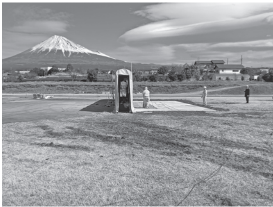
写真一八 評価試験状況 (騒音源：振動コンパクタ)
