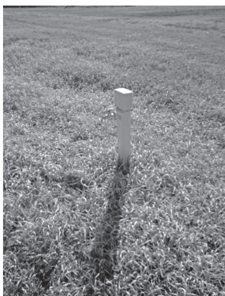
写真—2 ビーコン設置状況の例
