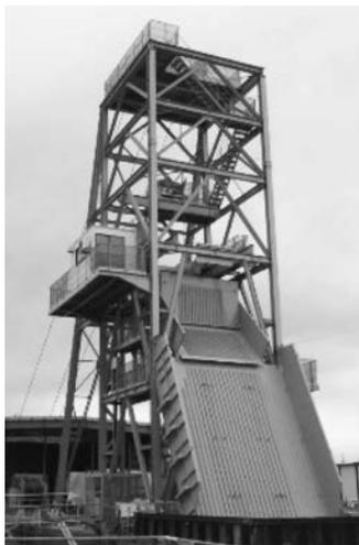
写真—10 立坑櫓設備 (西立坑)
