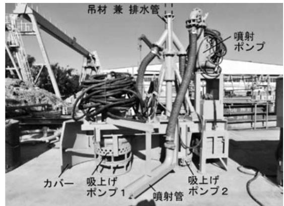
写真—2 スクレーパー型スライム処理機
