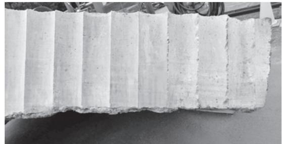
写真-5 杭底面外周部のコンクリート断面
