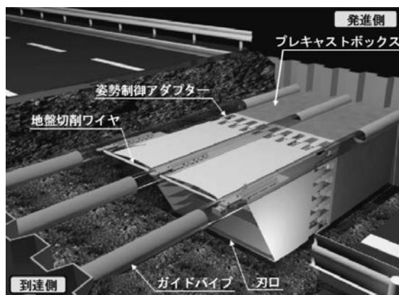
図一3 本工法施工概要
