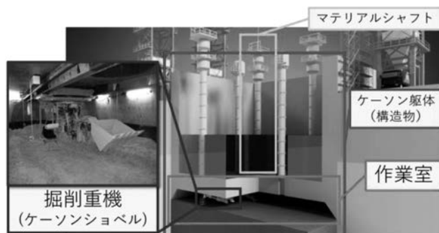
図-1 ニューマチックケーソン工法の概要図
