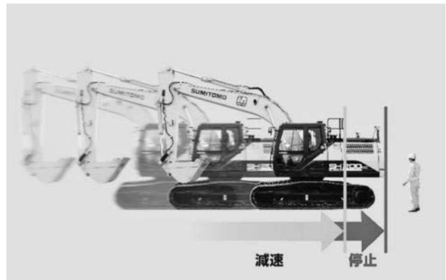
写真—3 後進・走行時の制動イメージ
