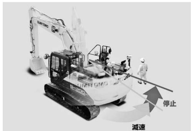
写真—4 旋回時の制動イメージ
