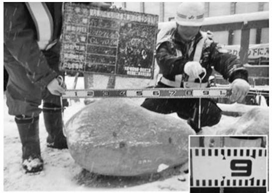
写真-3 巨礫 850mm×500mm×500mm
