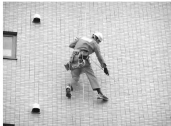
写真—1 全面打診による従来の外壁タイル調査例
