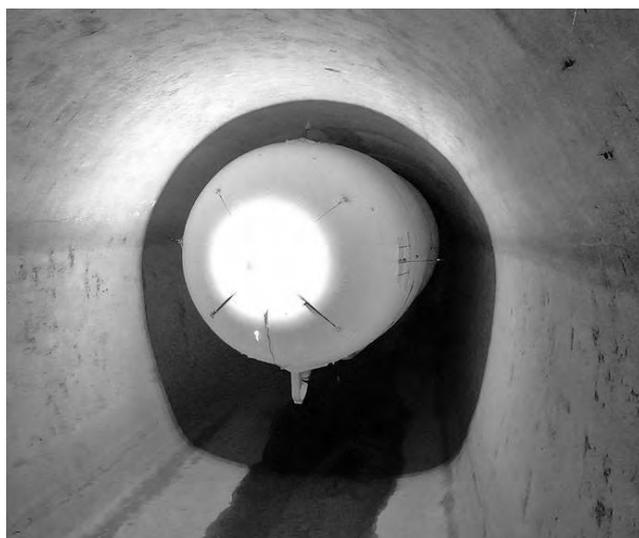
写真7 自律飛行による調査状況
