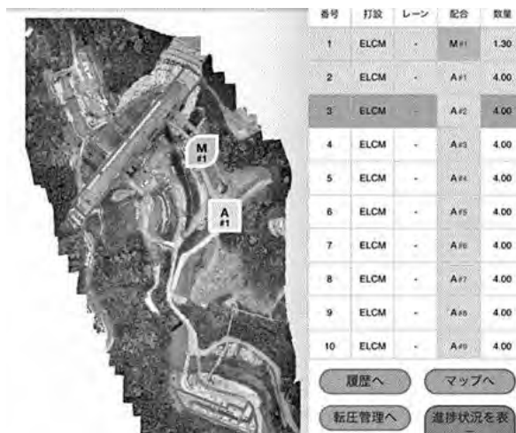
図-4 打設支援システム概要 (左: モニタ表示, 右: 全体概要)
