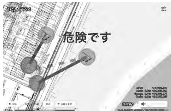
図-6 クレーン衝突防止システムの表示例
