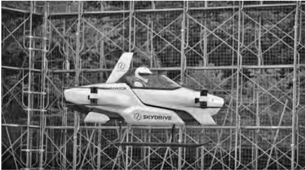
写真—6 「有人試験機 SD-03」モデルを使った有人飛行試験の様子(2020年8月初旬に撮影)
