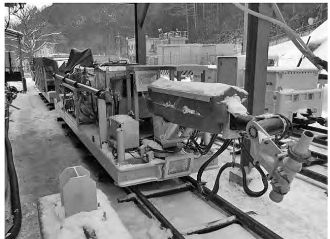
写真一〇 吹付ロボット台車
