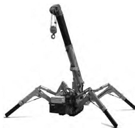
図-2 非乗車型ミニ・クローラクレーン
