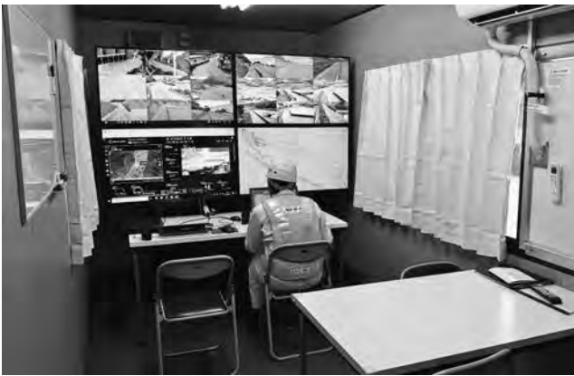
写真一 遠隔監視室
