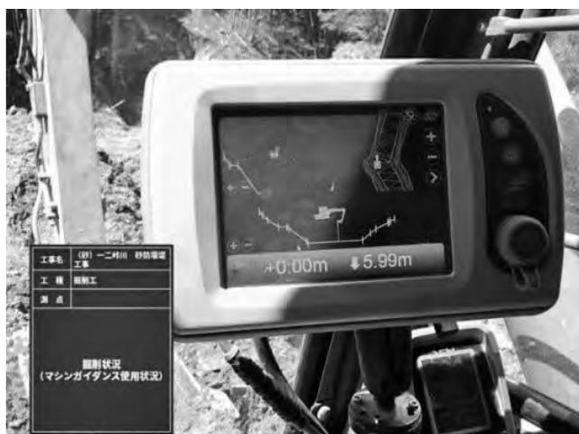
写真—4 バックホウ内部モニター
