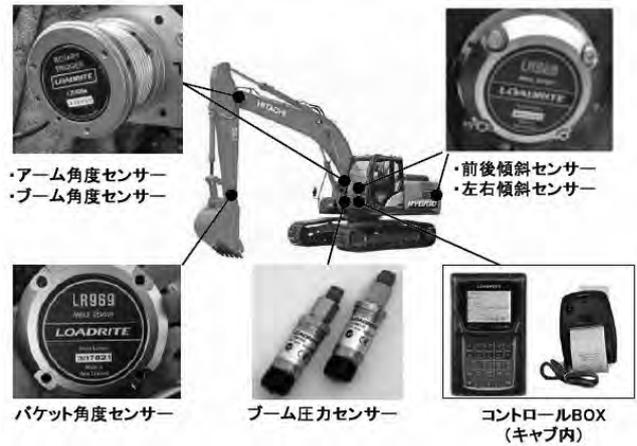
図-4 『ロードライト』装置の概要
