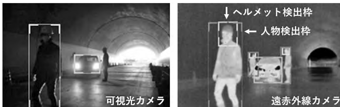
写真一 1 暗闇での可視光カメラ（左）と遠赤外線カメラ（右）の画像比較
