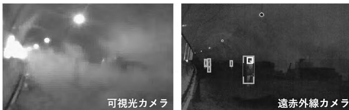
写真一 2 粉塵での可視光カメラ（左）と遠赤外線カメラ（右）の画像比較
