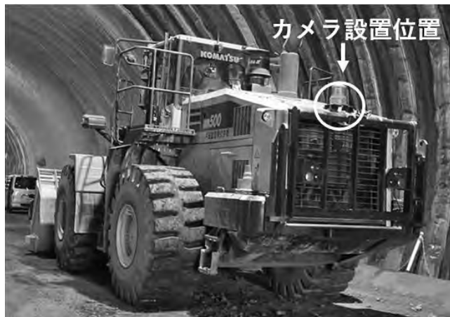
写真一5 ホイールローダへの設置状況
