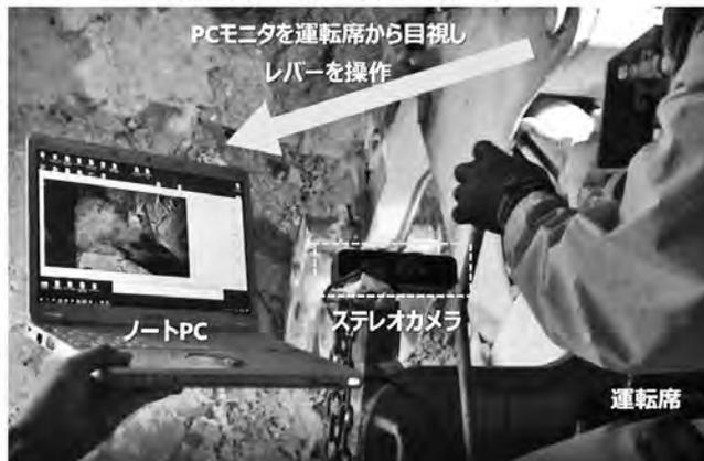
図一五 距離計カメラによる実験機器設置状況図
