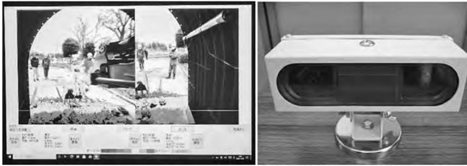
図-9 遠近距離可視化システム画面 (左: 操作用表示画面 右: カメラ本体)
