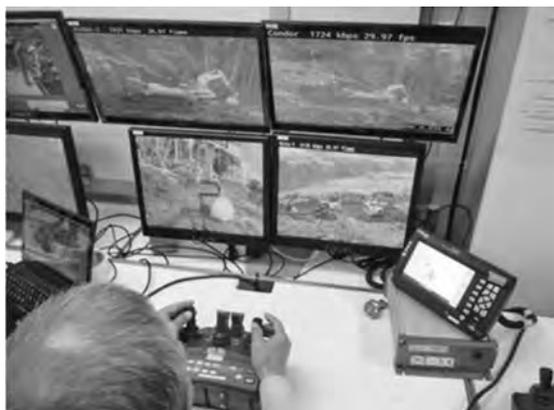
写真一 1 モニター使用の遠隔操作状況
