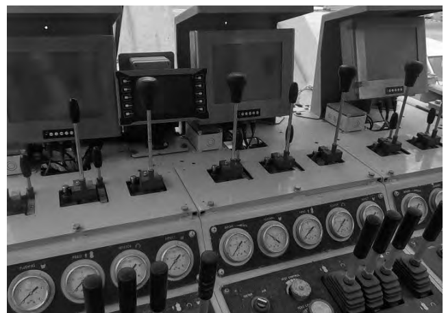
写真—5 電磁バルブ化した運転席
