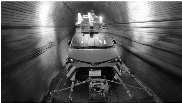
写真-2 伊豆急行線トンネル内を走行する移動計測車両「MMS」
