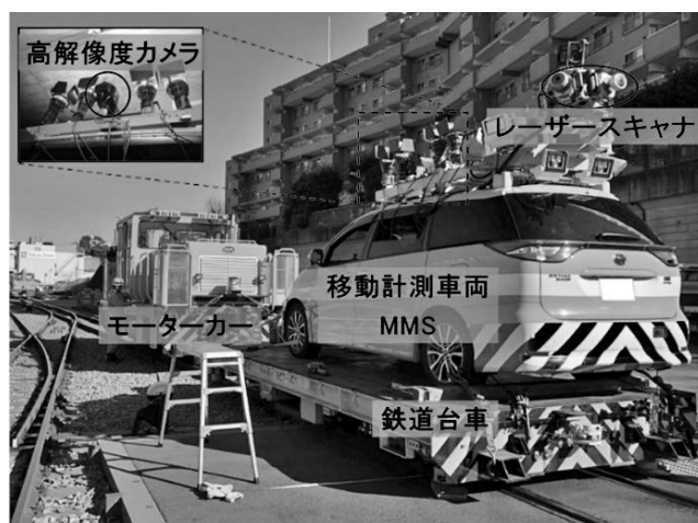
写真-1 鉄道台車に積載した移動計測車両「MMS」
