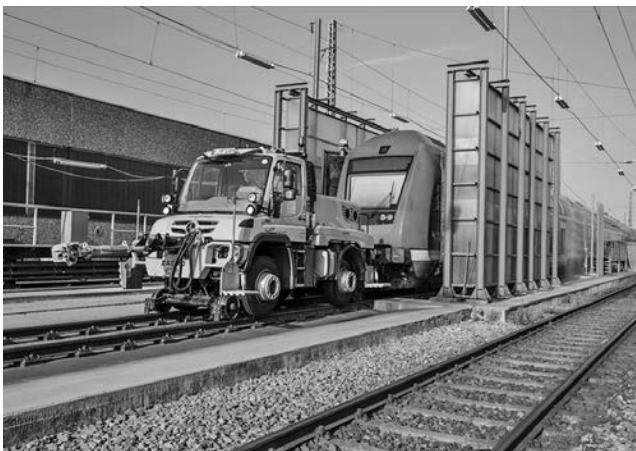
写真—4 ドイツ鉄道の車両牽引作業
