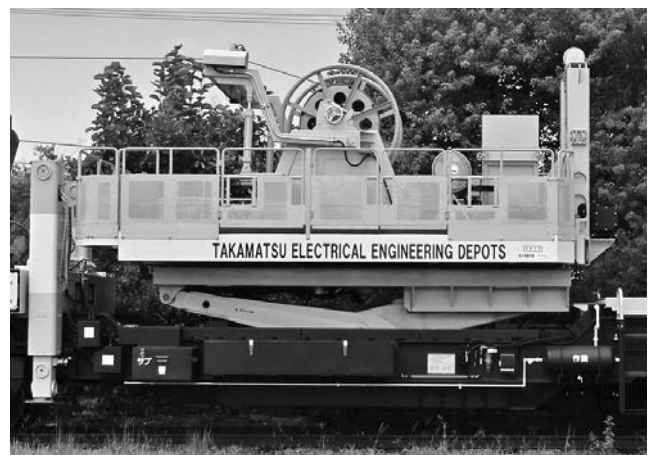
写真— 4 架線延線巻取装置, 搭載状態
