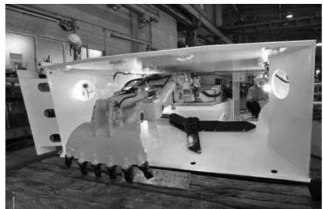
写真—3 バケットタイプ掘削装置(広幅タイプ)
