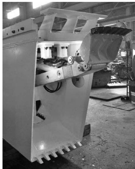
写真—2 バケットタイプ掘削装置(縦型タイプ)
