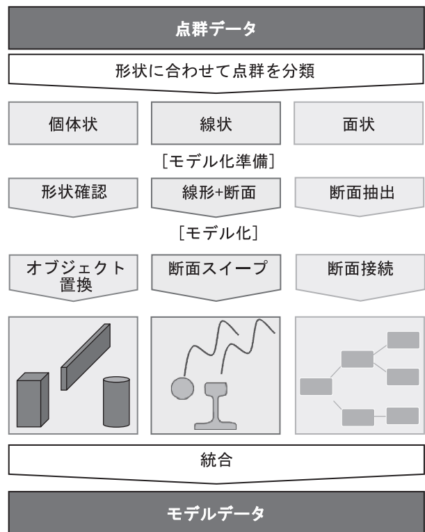
図-11 点群データ変換フロー図
