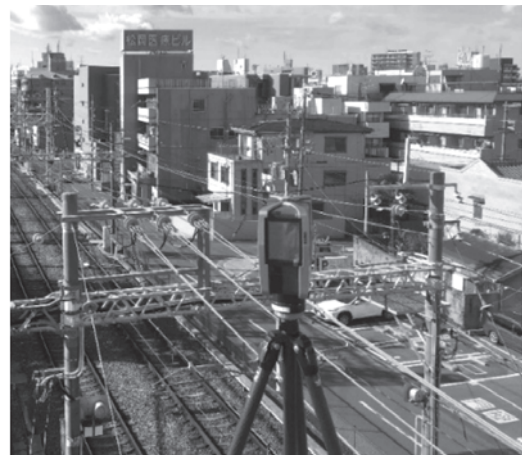
写真一2 3D スキャナによる現況計測状況
