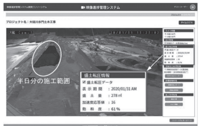
図一 5 振動ローラの GNSS データの重畳表示
