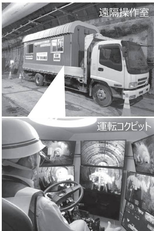
写真一2 遠隔操作室および運転コクピット
