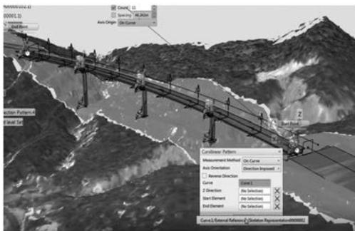
図一八 道路線形に床板と橋脚のテンプレートを配置する
