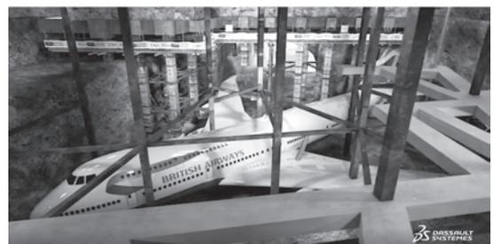
図一5 地下大空間を、既存施設を支えながら掘削する工事は一番の難関。各セクションをポールで支持しながら掘削を進める方法と手順の検討がBIM/CIMモデルで何種類か検討された
