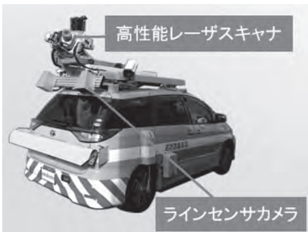
図一3 路面性状調査用 MMS
