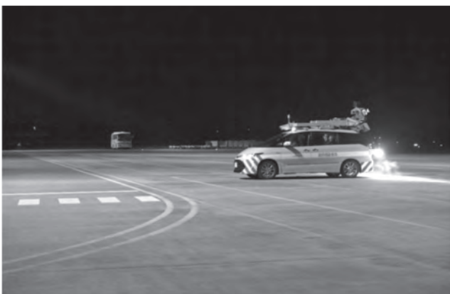
写真一 空港滑走路における路面性状調査の状況
