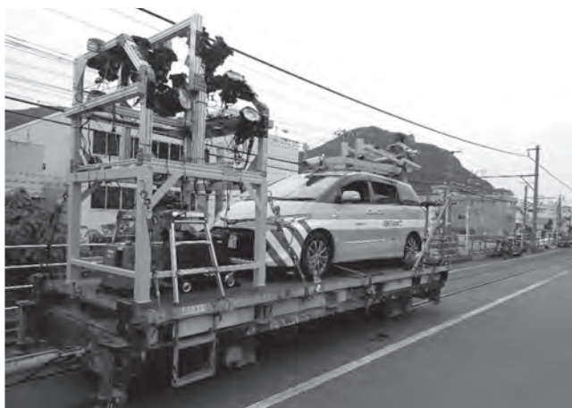
写真一3 トンネル点検用MMS
