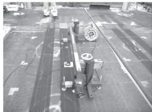
写真一 10 段差量の計測状況
