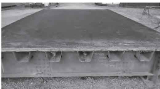
写真一 6 実物大の鋼床版試験体
