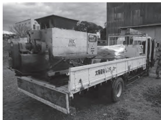
写真—12 専用溶融機 (300 kg 製造用)
