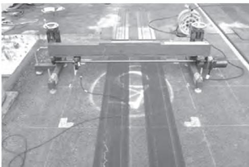
写真一 9 わだち掘れ量の計測状況
